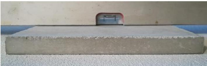
Assenza di curling (incurvamento) in una piastra di RALLK **UltraLevel K** di 18 mm di spessore dopo 28 giorni di maturazione in virtù di un **ritiro totale inferiore ai 200 μm**.
