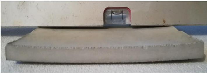
Comparsa di curling (incurvamento) in una piastra di altra Lisciatura autolivellante di 18 mm di spessore dopo 28 giorni di maturazione in conseguenza di un **ritiro totale superiore ai 500 μm**.
