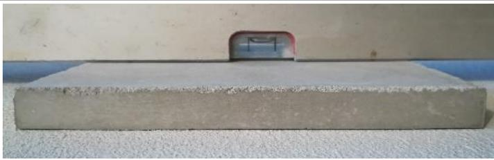
Assenza di curling (incurvamento) in una piastra di RALLK **UltraLevel K** di 18 mm di spessore dopo 28 giorni di maturazione in virtù di un **ritiro totale inferiore ai 200  $\mu\text{m}$** .
