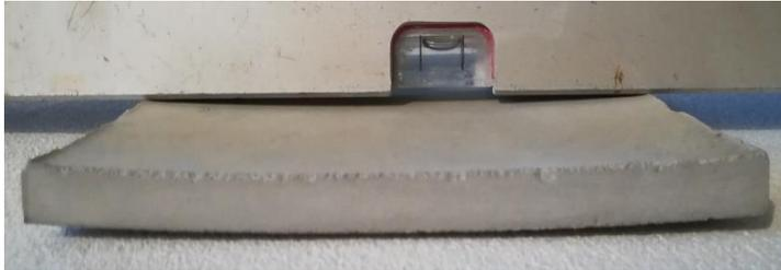
Comparsa di curling (incurvamento) in una piastra di altra Lisciatura autolivellante di 18 mm di spessore dopo 28 giorni di maturazione in conseguenza di un **ritiro totale superiore ai 500  $\mu\text{m}$** .
